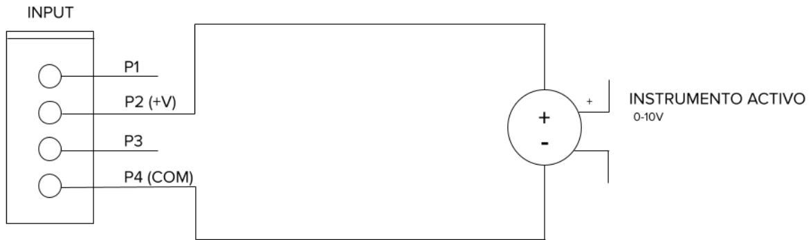
Figura 15 - Conexión de instrumentos activos para medición de tensión.
