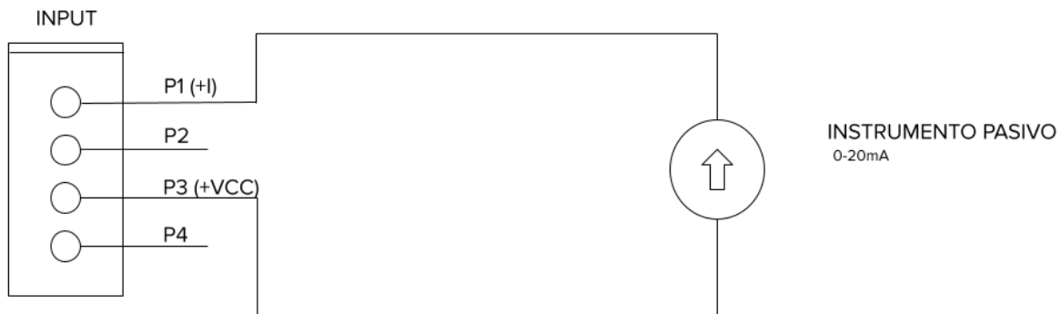
Figura 14 - Conexión de instrumentos pasivos para medición de corriente.
